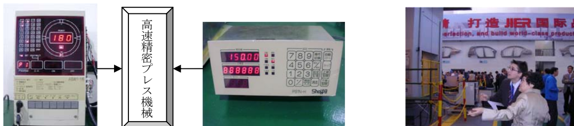
電子制御機器の使用例：左（角度制御機器）、右（位置制御機器）
