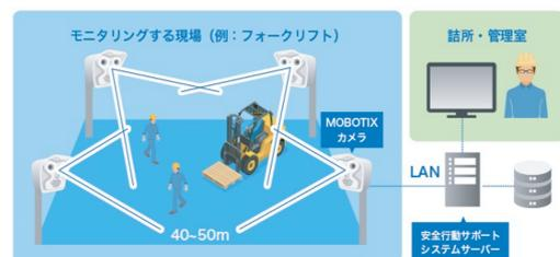
図はフォークリフトに設置された近接センサーで検知したニアミス事象をトリガーとした例
