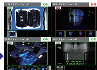
撮影した画像は、画像処理コントローラで処理し、PC に内蔵された AI ソフトで判断
