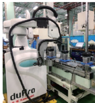
カメラで上面、側面、底面各部の画像を撮影
