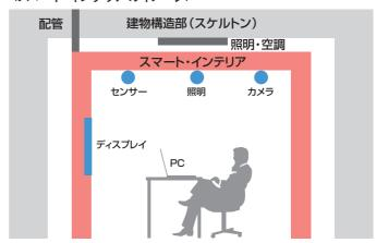
そこで、北梅田では情報設備を内装に埋め込ん で「隠す」といった従来の工法ではなく、情報設備を 建物から切り離し、情報設備自体を内装とする「ス マート・インテリア | としてデザインすることを提案して いる。
